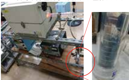
液化したアンモニアとそれを利用した超高純度アンモニア窒化反応炉(1000℃で反応中のような)
